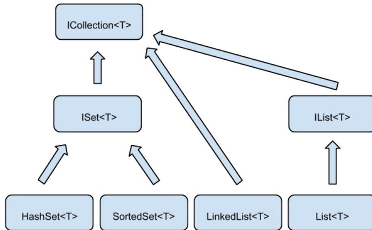
Além disso, aprendemos que podemos utilizar o `foreach` com qualquer coleção do C#. Isso acontece porque o `foreach` aceita qualquer classe que implemente a interface `IEnumerable`, que é uma super interface (interface pai) da `ICollection`:
